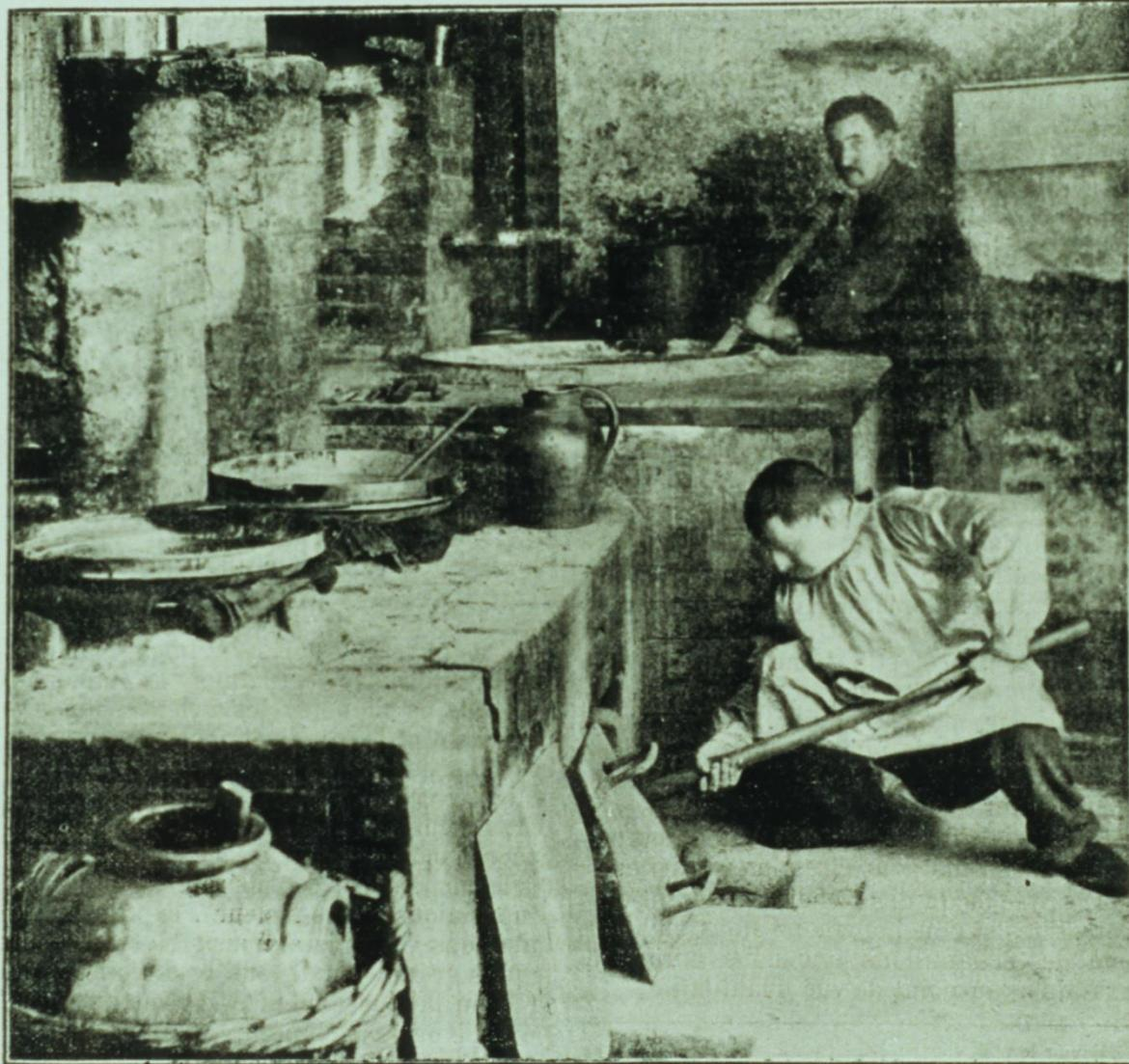
Fig. 1. — Traitement des résidus par la soude concentrée et bouillante.
